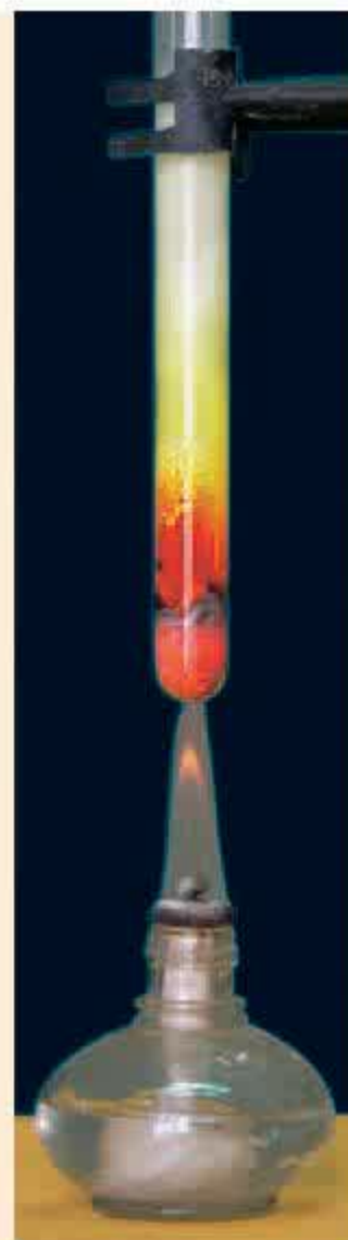
Hình 2.20. Thí nghiệm sắt tác dụng với lưu huỳnh
