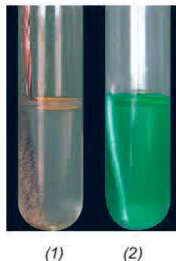
Hình 2.7. 1 - Đồng phản ứng với dd \text{AgNO}_3 2 - Bạc không phản ứng với dd \text{CuSO}_4
