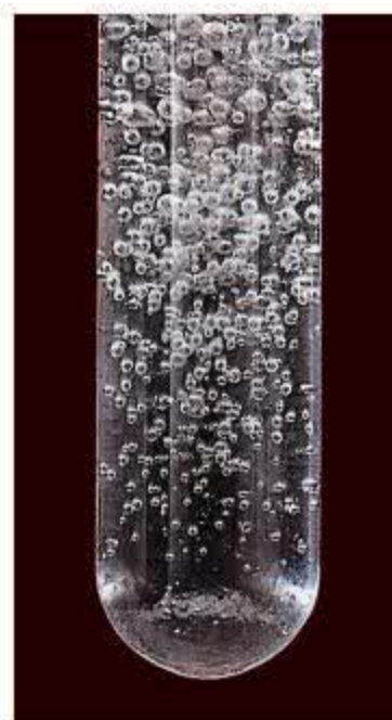
Hình 3.14. dd \text{NaHCO}_3 tác dụng với dd \text{HCl}
