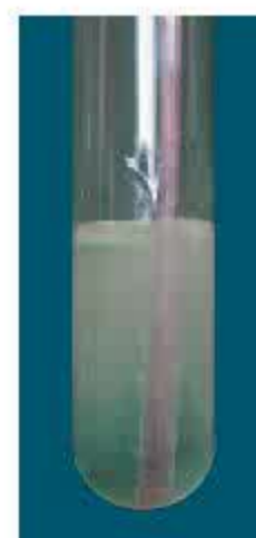
Hình 2.11. Nhôm phản ứng với dung dịch HCl
