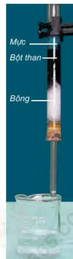
Hình 3.7. Thí nghiệm về sự hấp phụ màu của than gỗ
