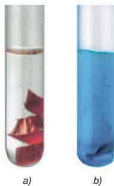
Hình 1.10. a) \text{H}_2\text{SO}_4 loãng không tác dụng với Cu b) \text{H}_2\text{SO}_4 đặc tác dụng với Cu
