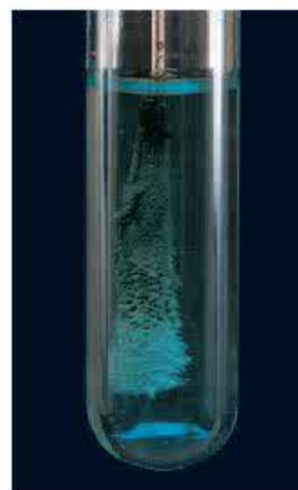
Hình 1.20. Cu tác dụng với dung dịch \text{AgNO}_3
