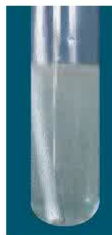
Hình 2.13. Nhôm phản ứng với dung dịch NaOH
