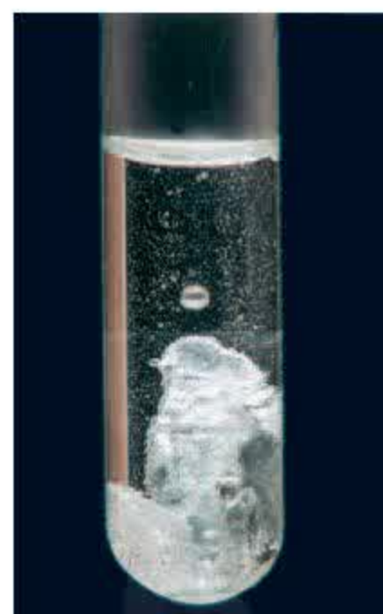
Hình 1.9. Nhôm tác dụng với dung dịch axit
