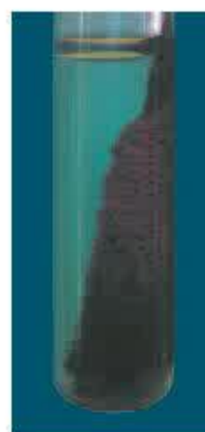
Hình 2.12. Nhôm phản ứng với dung dịch CuCl 2
